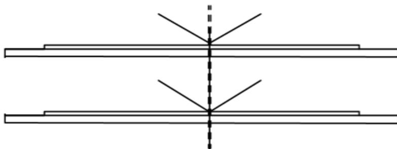
雙電刷等於雙迴路輸出.當電刷磨損後產生距離.原本輸出5.00V
